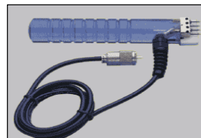
15-E, À tige, avec deux rangées de quatre tiges, pénétration max. 3 mm. La pénétration est réglable selon l'épaisseur du papier avec une cale-étalon.
