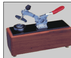
43-E, À pince pour vérifier feuilles minces. L'échantillon est comprimé entre deux disques lisses.
