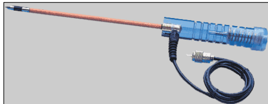
H4/830-2, Porte-électrode et sonde coaxiale de 25 cm. pour mesurer l'humidité dans des balles.
